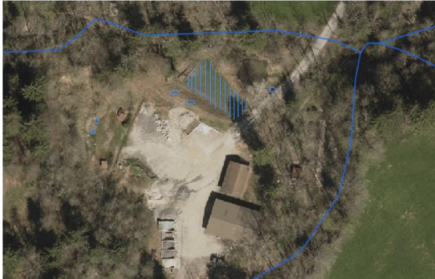
Abb. 3: Übersicht der Massnahmen zur Förderung der Gelbbauchunken in der Vorder Chuewart. Wannen und aufgestaute Becken= blaue Kreise. Mit dem Bagger zu strukturierende Fläche= blau schraffiert. (www.zugmap.ch)
